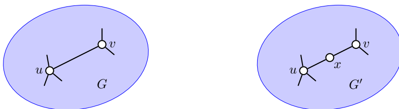
Obrázek 9.10.: Graf G s vyznačenou hranou uv a jeho rozdělení G' s přidáním vrcholem x .
